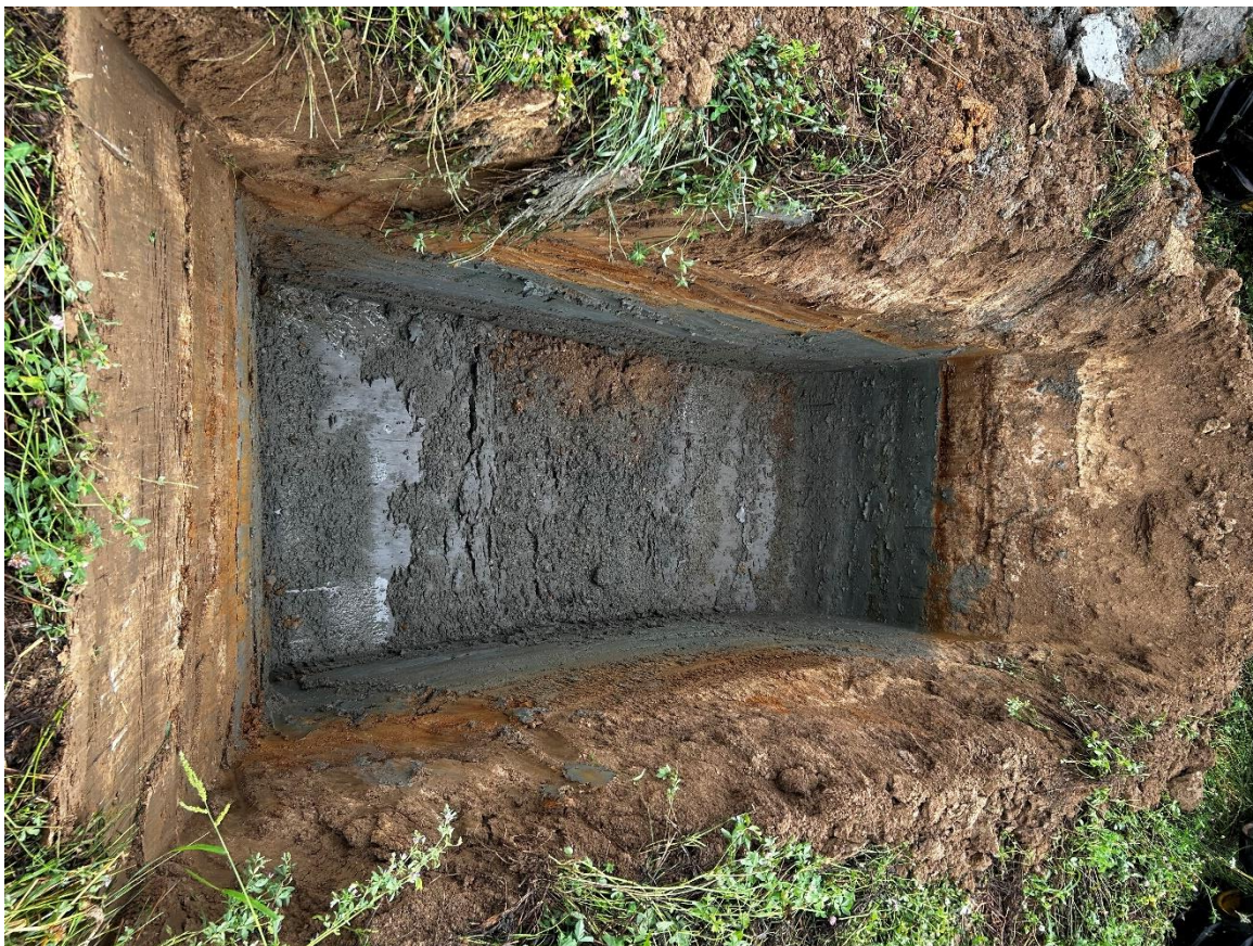
Obr. Kopaná sonda nad skruží č. 3, výrazný jílový horizont
