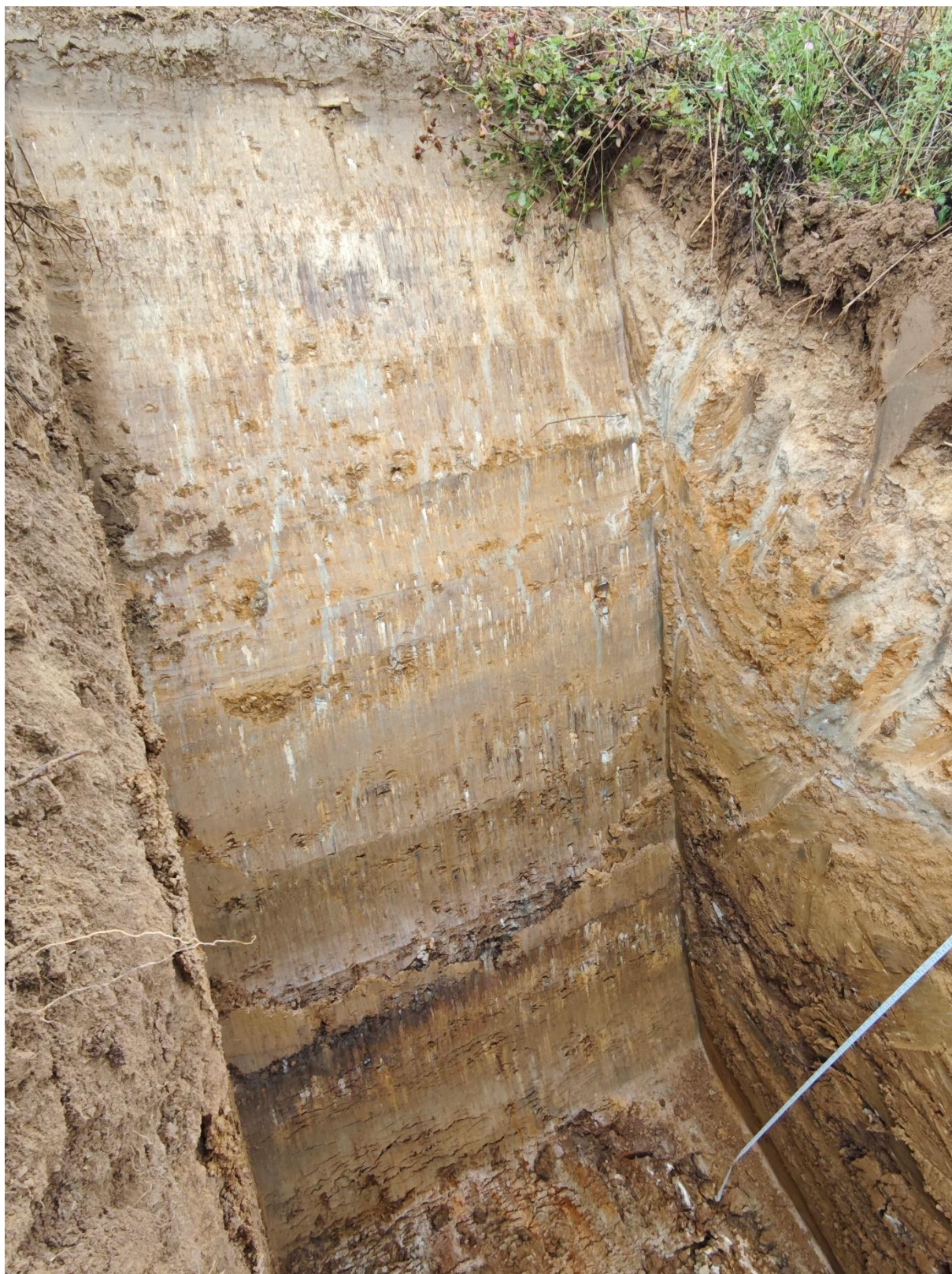
Obr. Kopaná sonda nad skruží č. 5 – odhalení svodného drénu v pravobřeží, již minimum jílové zeminy
